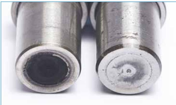
À gauche, un injecteur diesel encrassé suite à l'utilisation d'un carburant classique. À droite, un injecteur propre, grâce à la technologie du GASOIL 50 POWER MAX
